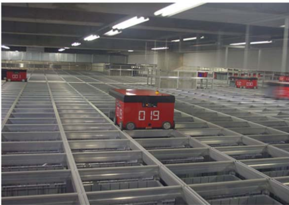
コンテナ上部を自動走行し、商品を出し入れするロボット(川崎市のホームロジスティクス通販発送センター)
